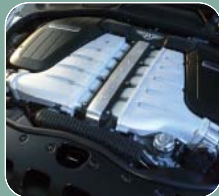
Der Continental GT besitzt den derzeit kürzesten 12-Zylinder-Serienmotor.
