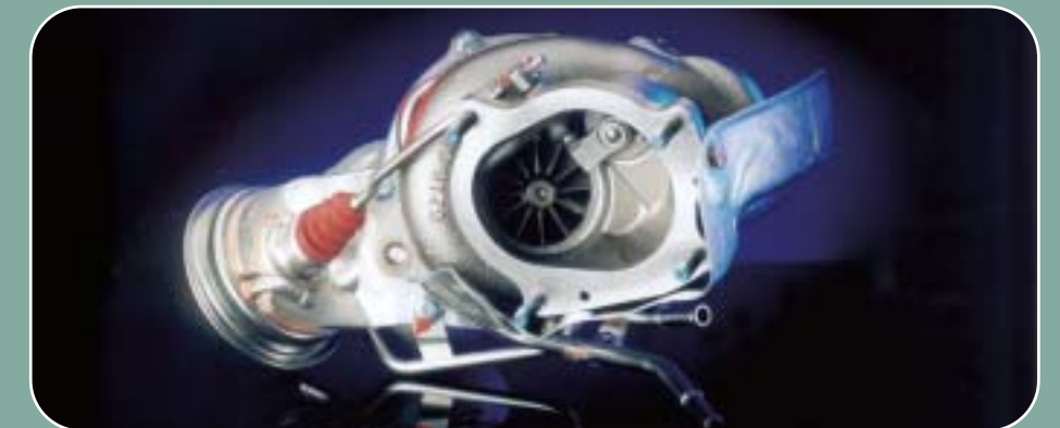
Zwei K16 Turbolader tragen dazu bei, dass das maximale Drehmoment schon bei 1.600 U/min erreicht wird.
