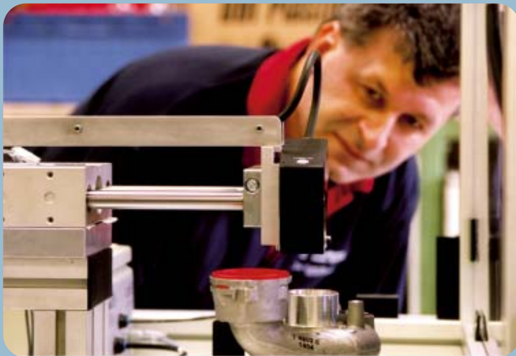
Mit Hilfe von Kameras und Lasertechnik werden die Bauteile geprüft und vermessen.
